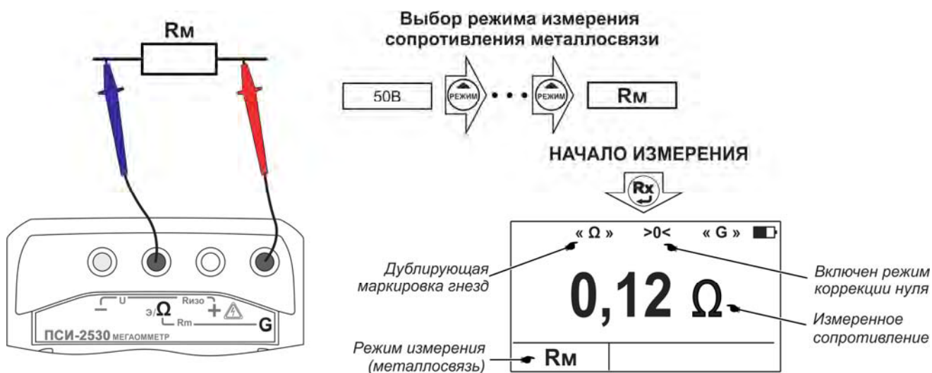
Рисунок 2.8 - Измерение сопротивления металlosвязи
