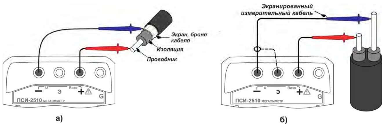
Рисунок 2.11 - Измерение сопротивления изоляции
