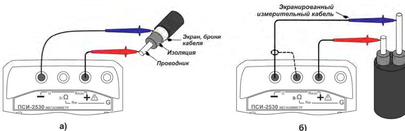
Рисунок 2.5 - Измерение сопротивления изоляции кабеля
