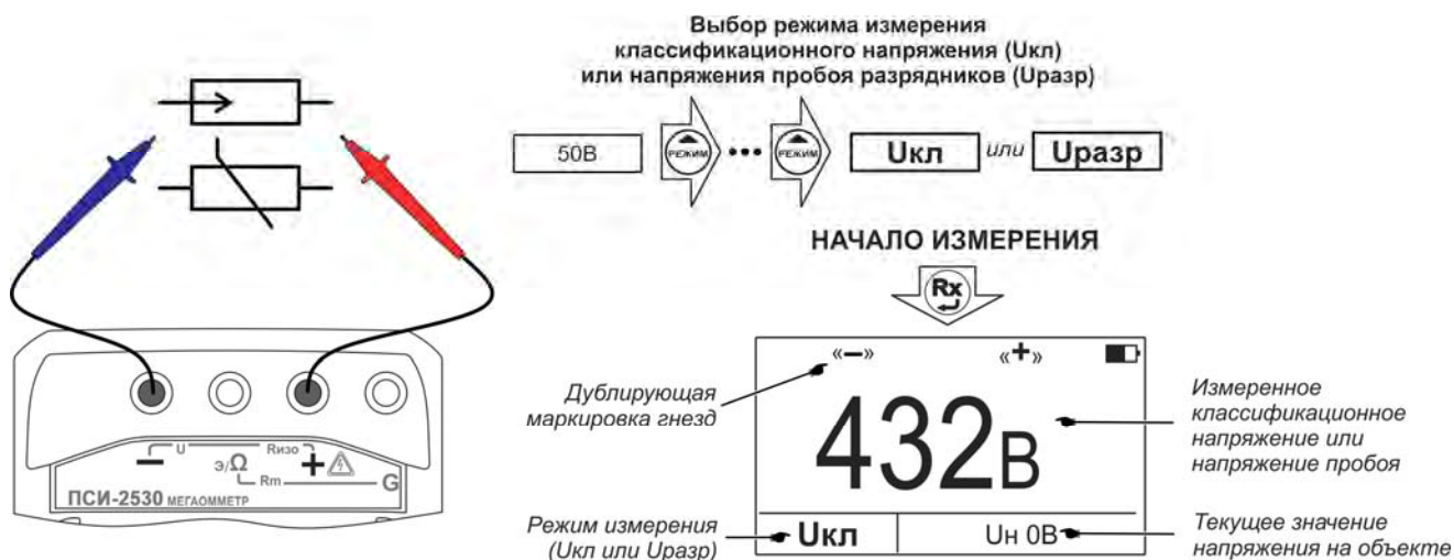
Рисунок 2.10 - Измерение классификационного напряжения или напряжения пробоя разрядников
